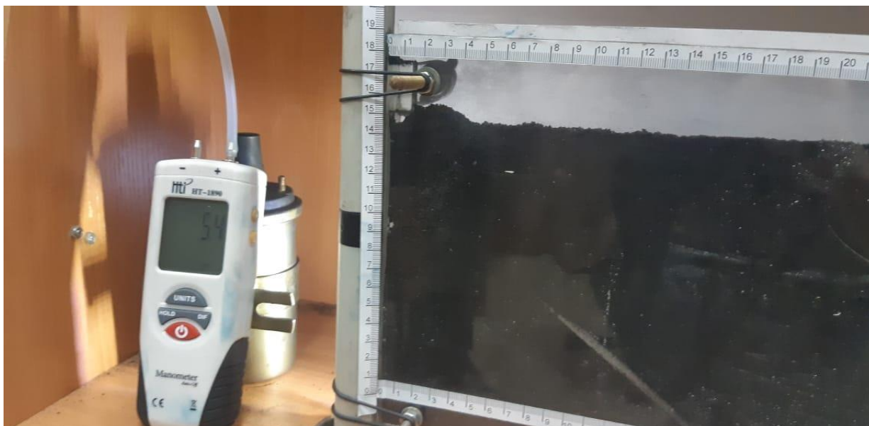
Рисунок В.25 – Параметры воздушного потока при d = 4 мм, P = 5 мбар
