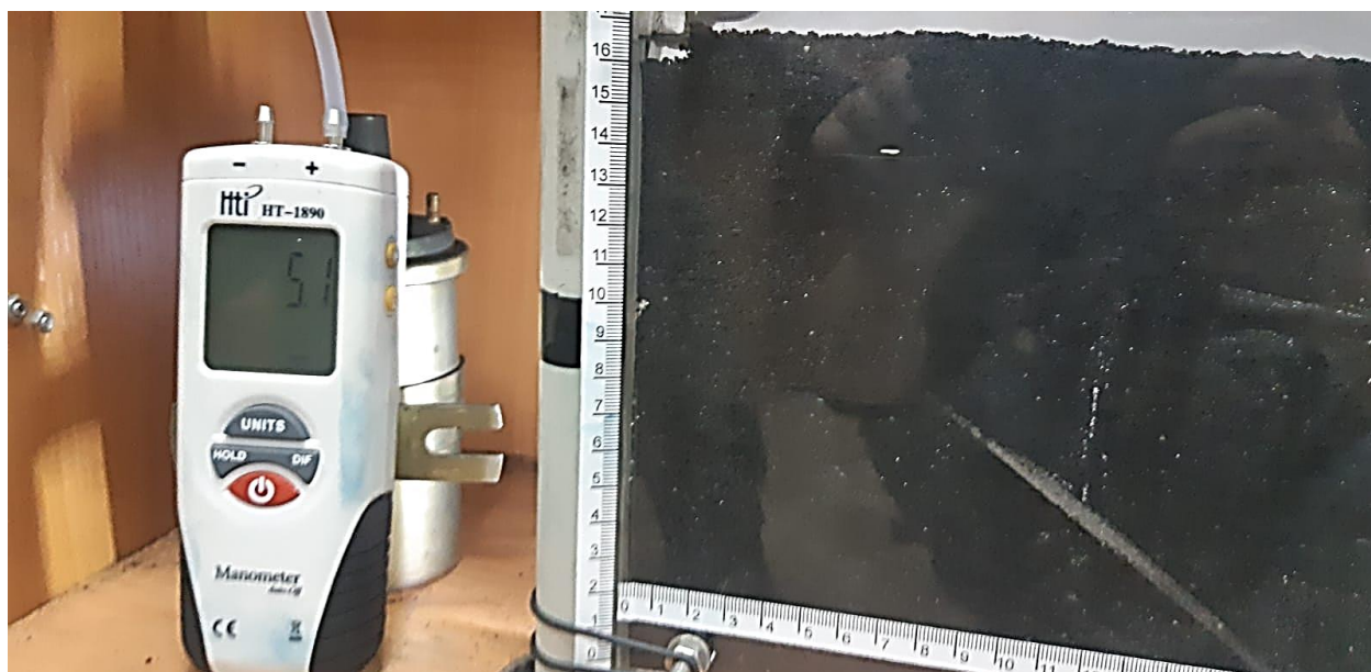
Рисунок В.27 – Параметры воздушного потока при d = 5 мм, P = 5 мбар
