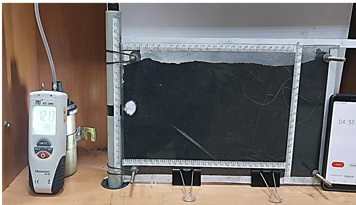
Рисунок В.19 – Параметры воздушного потока при d = 2 мм, P=120 мбар
