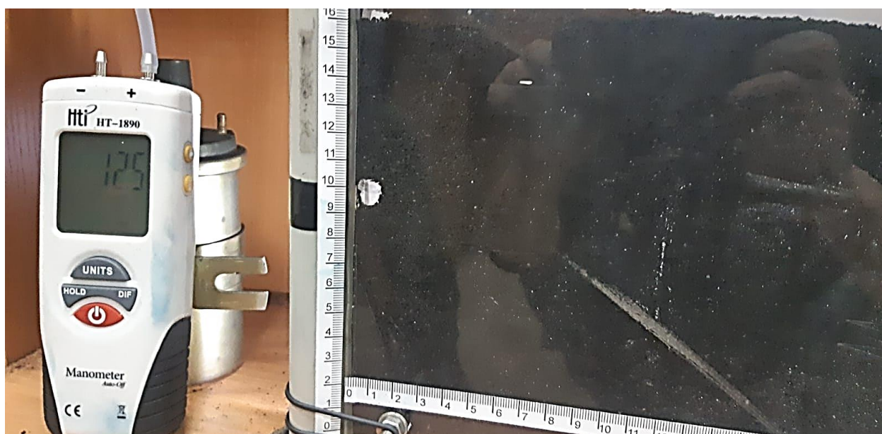
Рисунок В.28 – Параметры воздушного потока при d = 5 мм, P = 12,5 мбар
