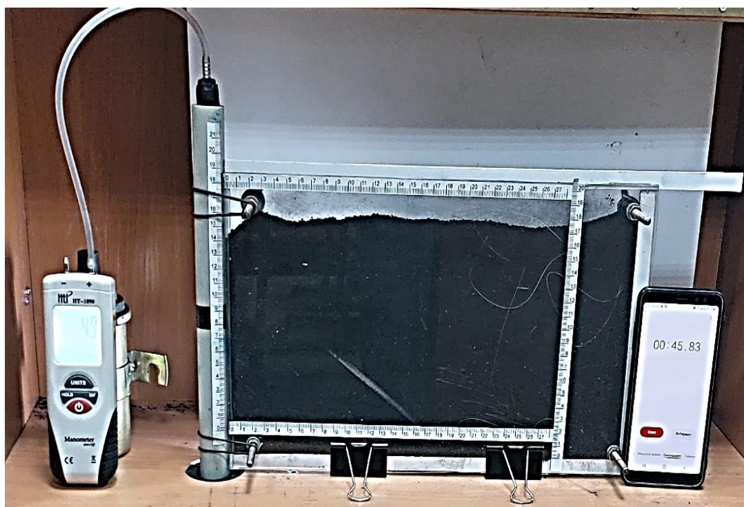
Рисунок В.16 – Параметры воздушного потока при d = 2 мм, P = 5 мбар
