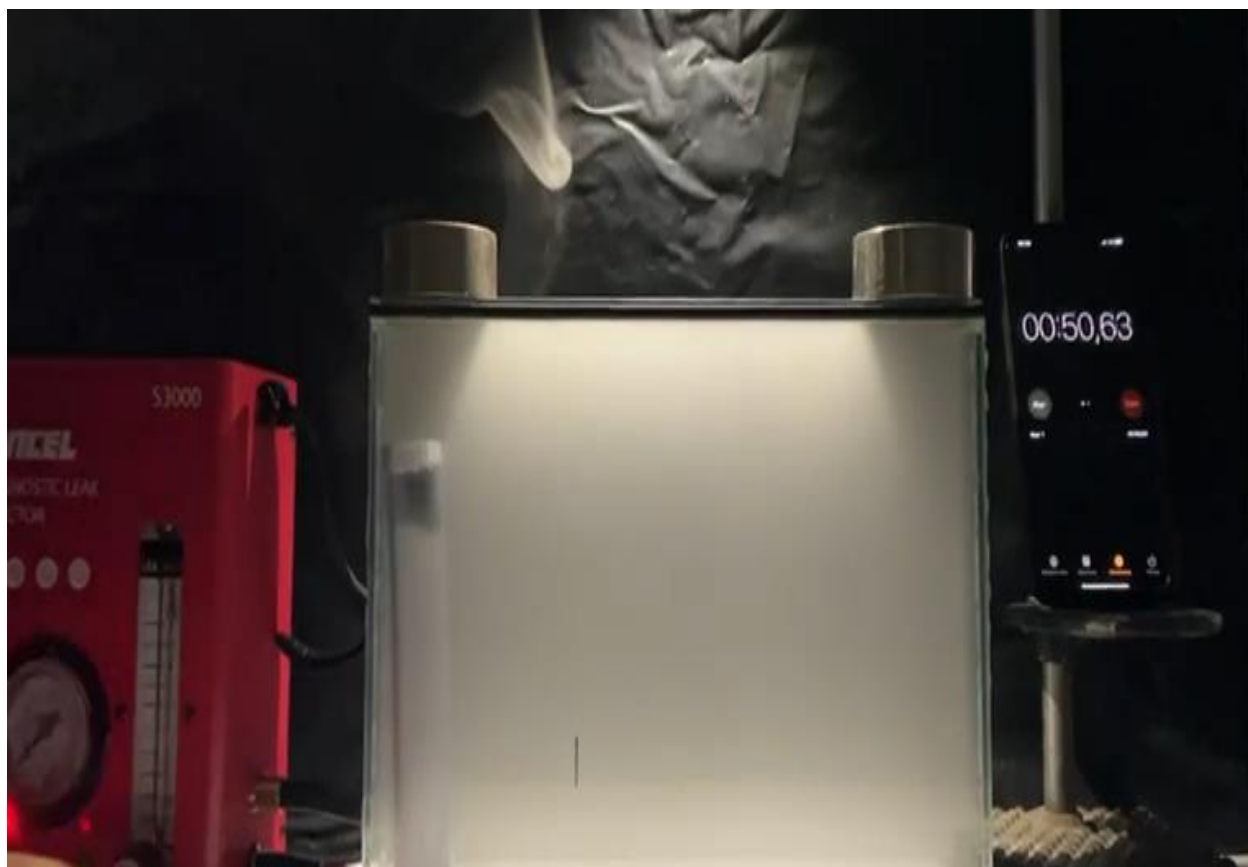
Рисунок В.32 – Параметры воздушного потока при отсутствии слоя угля диаметр отверстия 4 мм
