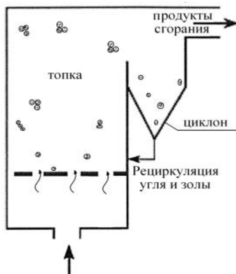
Рисунок 1.6 – Циркулирующий кипящий слой (ЦКС)
