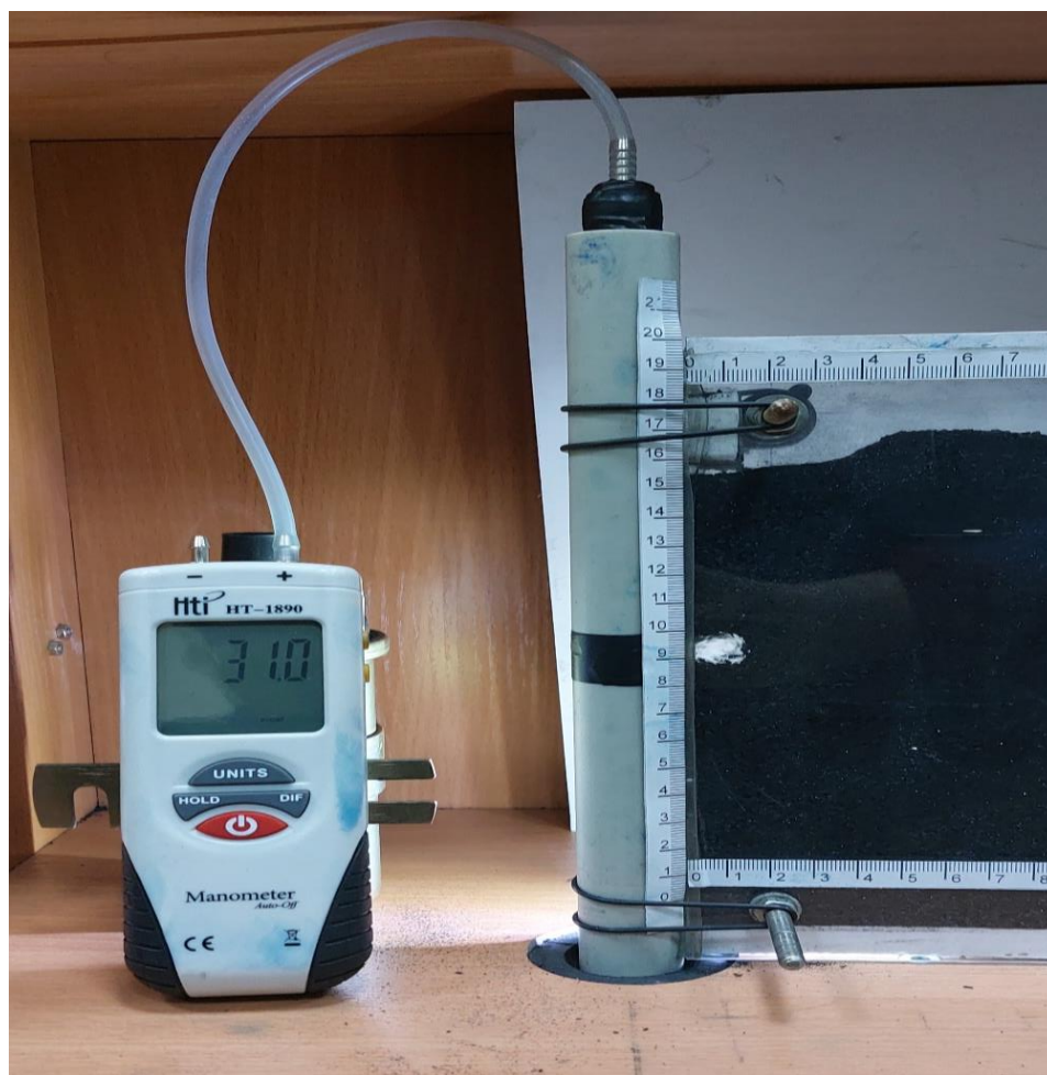
Рисунок В.24 - Опыт 3 P = 31\text{ мбар} , d = 3\text{ мм}
