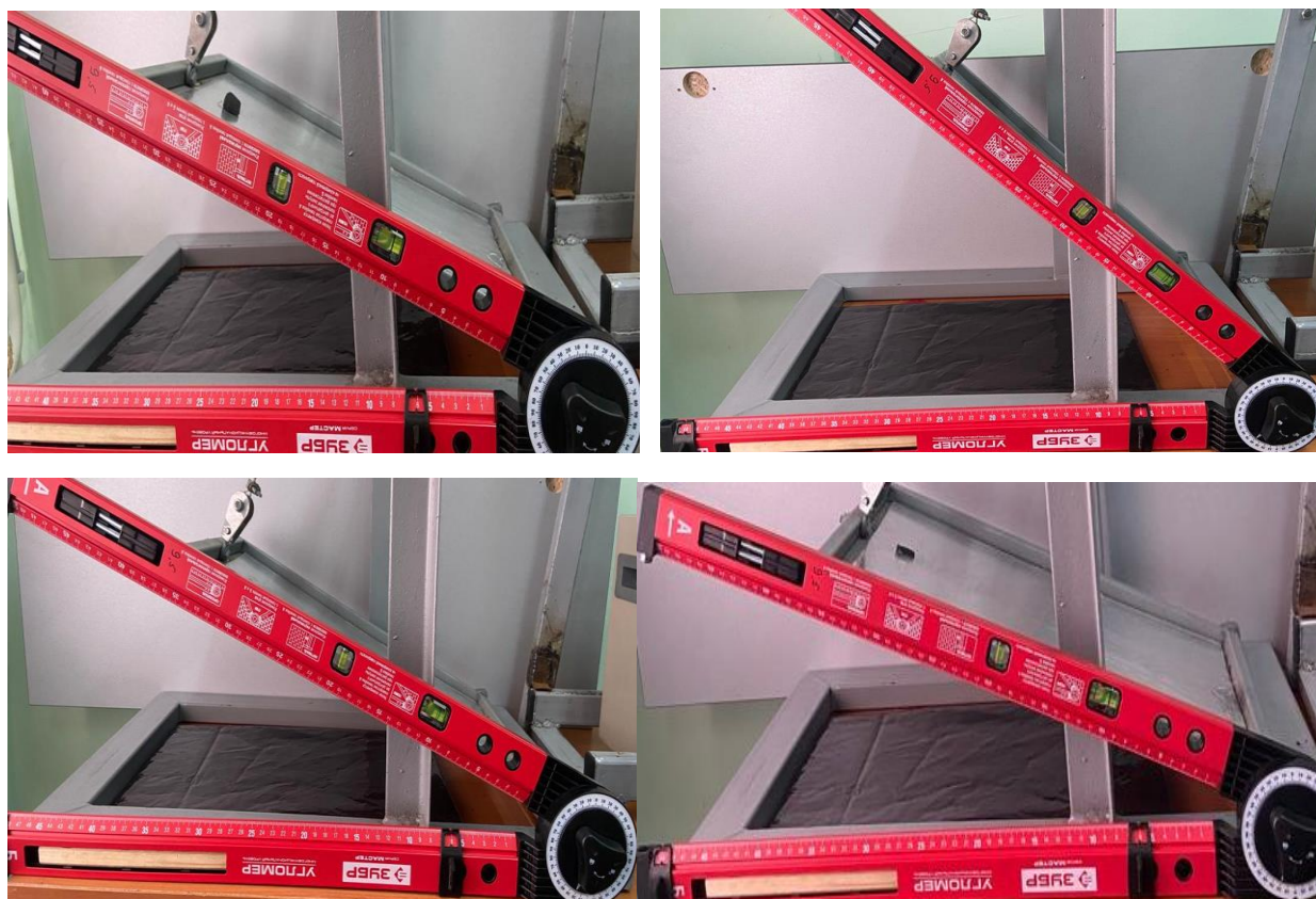
Рисунок В.15 – Устройство для определение градуса естественного откоса угля различных марок при различном гранулометрическом составе
