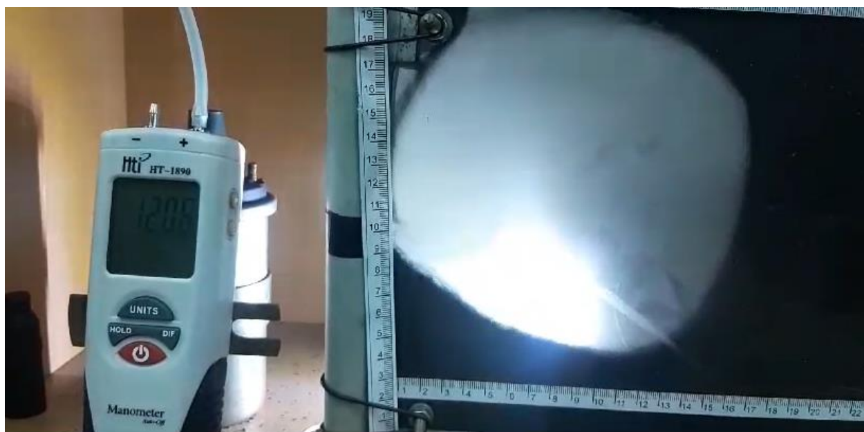
Рисунок В.29 – Параметры воздушного потока при d = 5 мм, P = 120 мбар
