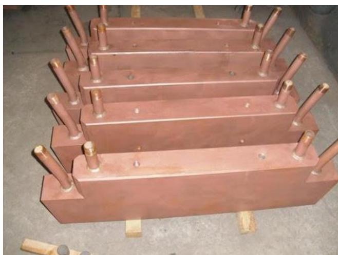
Рисунок 1.17 – Медные холодильники и кессоны для водяного охлаждения различных металлургических печей
