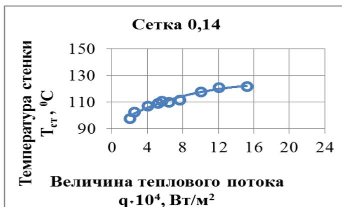
Рисунок 4.2.1 – Зависимость температуры стенки от плотности теплового потока для сетки  $0,14 \times 10^{-3}$  м
