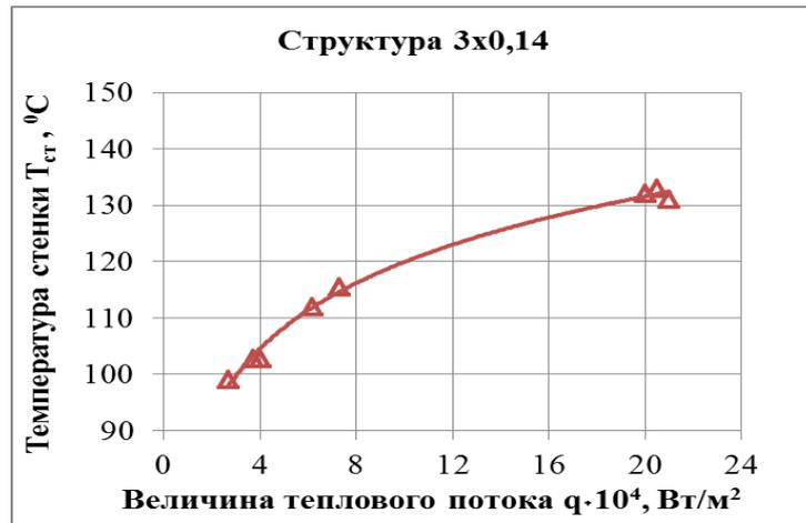
Рисунок 4.2.2 – Зависимость температуры стенки от плотности теплового потока для структуры  $3 \times 0,14 \times 10^{-3}$  м
