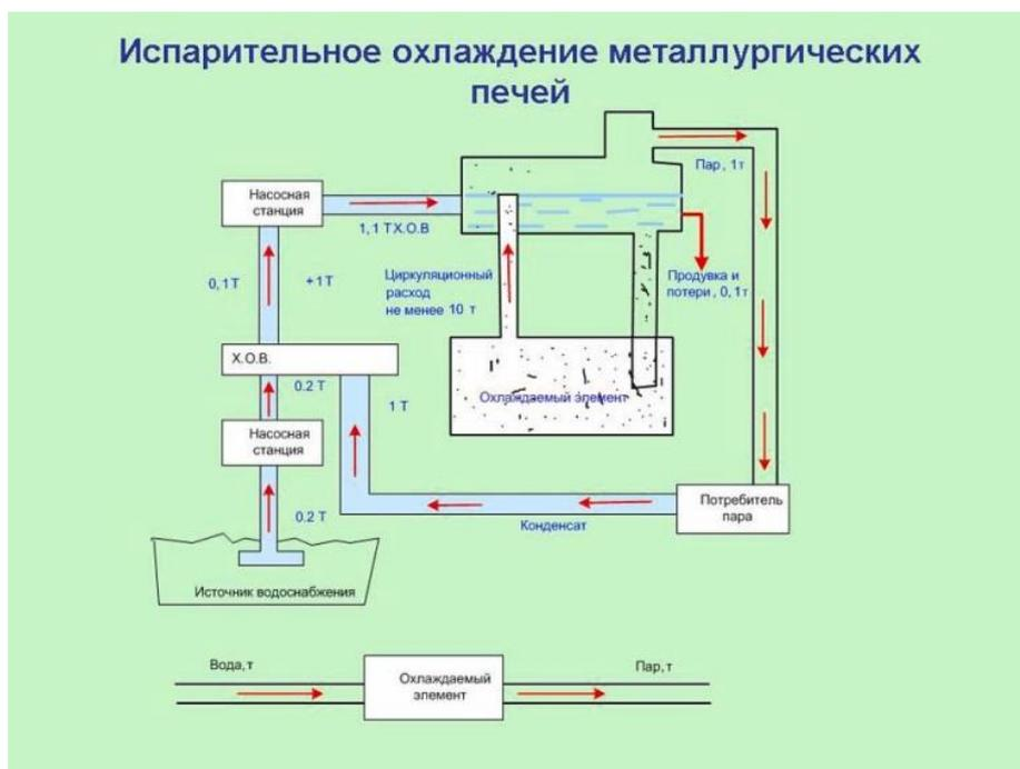
Рисунок 1.18 – Испарительное охлаждение металлургических печей [55]
