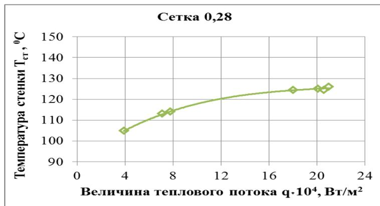
Рисунок 4.2.3 – Зависимость температуры стенки от плотности теплового потока для сетки  $0,28 \times 10^{-3}$  м
