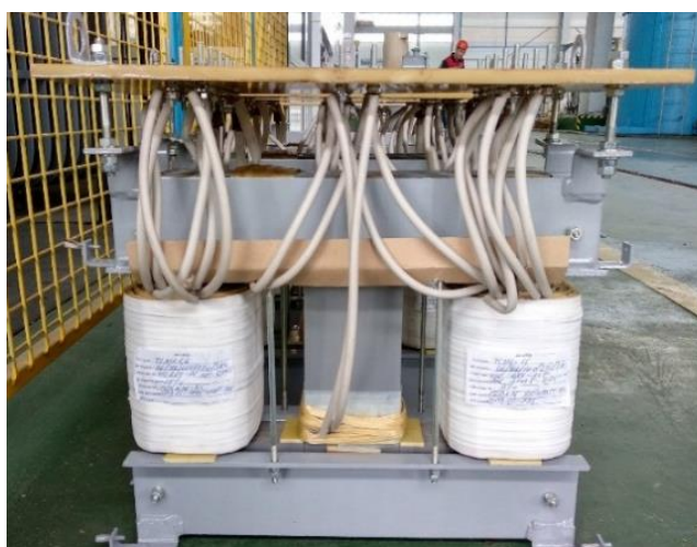
Рисунок 2.3 – Общий вид и размеры одной фазы физической модели реактора
