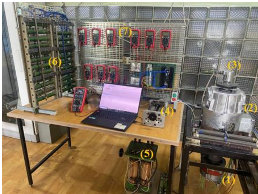
Рисунок 3.3 – Общий вид испытательного стенда: ВГШД (1), приводной двигатель М (2), тахогенератор (3), реостат регулирования скорости вращения (4), автотрансформатор (5), активная нагрузка (6), измерительные приборы (7)
