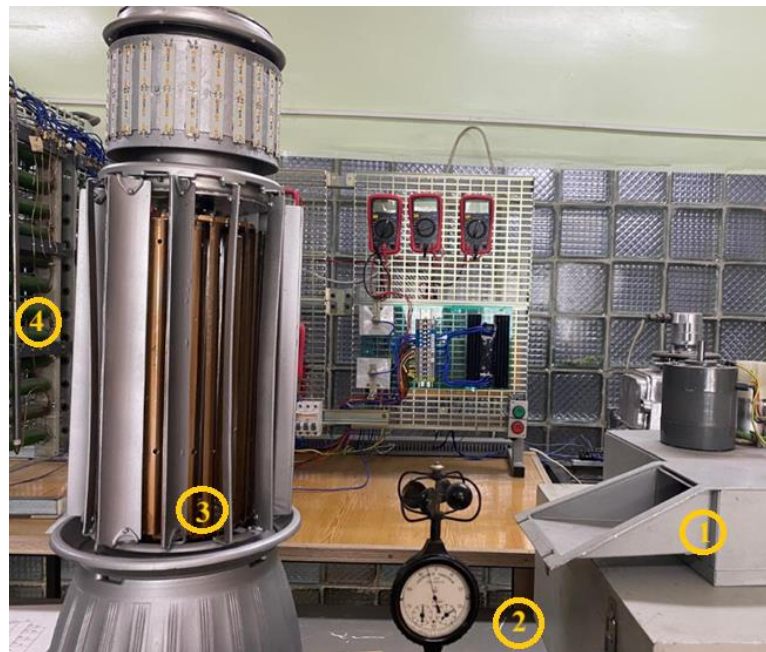
Рисунок 1.3 – Физическая модель ВВТ: 1 - источник ветрового потока (вентилятор); 2 – анемометр чашечный; 3 – модель ВГШД; 4 – нагрузка.
