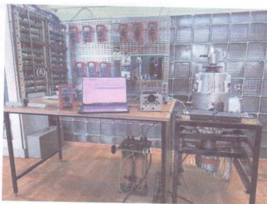
Рисунок 2 - Общий вид испытательного стенда: 1 – ВГШД; 2 - двигатель ПЗ2М; 3 – тахогенератор; 4 – АТ; 5 – блок выпрямителей; 6 – нагрузки.
