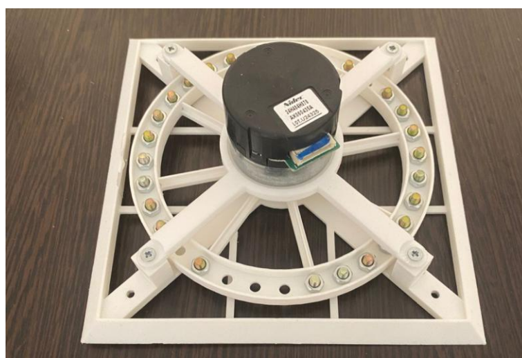
Рисунок 4.3 – Собранный маховичный узел с двигателем Nides 24N и инерционным диском
