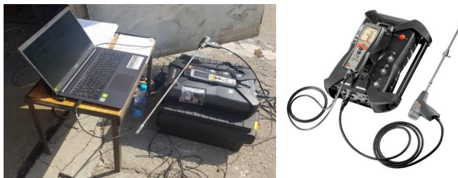
Сурет 3.5 – Testo-350 газ талдағышы
