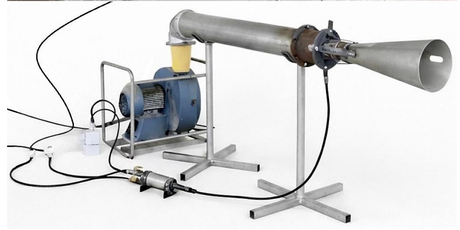
Сурет 3.2 – Фронттық құрылғылар мен оттықтарды зерттеуге арналған стендтің көрінісі
