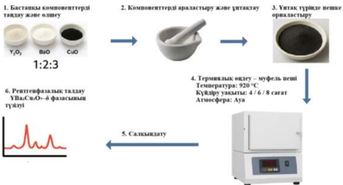
17 - сурет. YBa_2Cu_3O_{7-x} фазасын синтездеу процесінің схемасы
