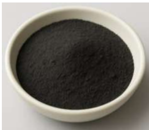
Сурет 18 – \text{YBa}_2\text{Cu}_3\text{O}_{7-x} негізіндегі үлгілердің ұнтақ (порошок) күйіндегі пішіні
