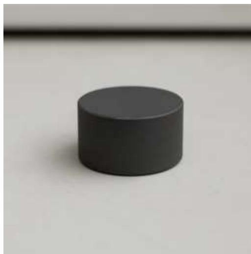
Сурет 20 – \text{YBa}_2\text{Cu}_3\text{O}_{7-x} негізіндегі үлгілердің цилиндрлік таблетка түріндегі морфологиясы
