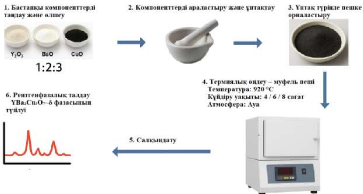
Сурет 17 – YBa_2Cu_3O_{7-x} фазасын синтездеу процесінің схемасы
