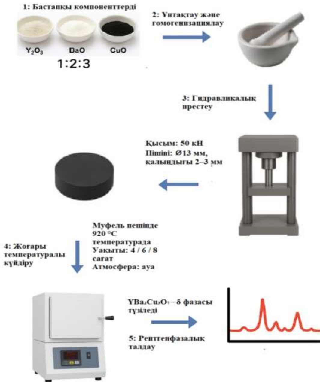
Сурет 21– \text{YBa}_2\text{Cu}_3\text{O}_{7-x} фазасын синтездеу процесінің схемасы
