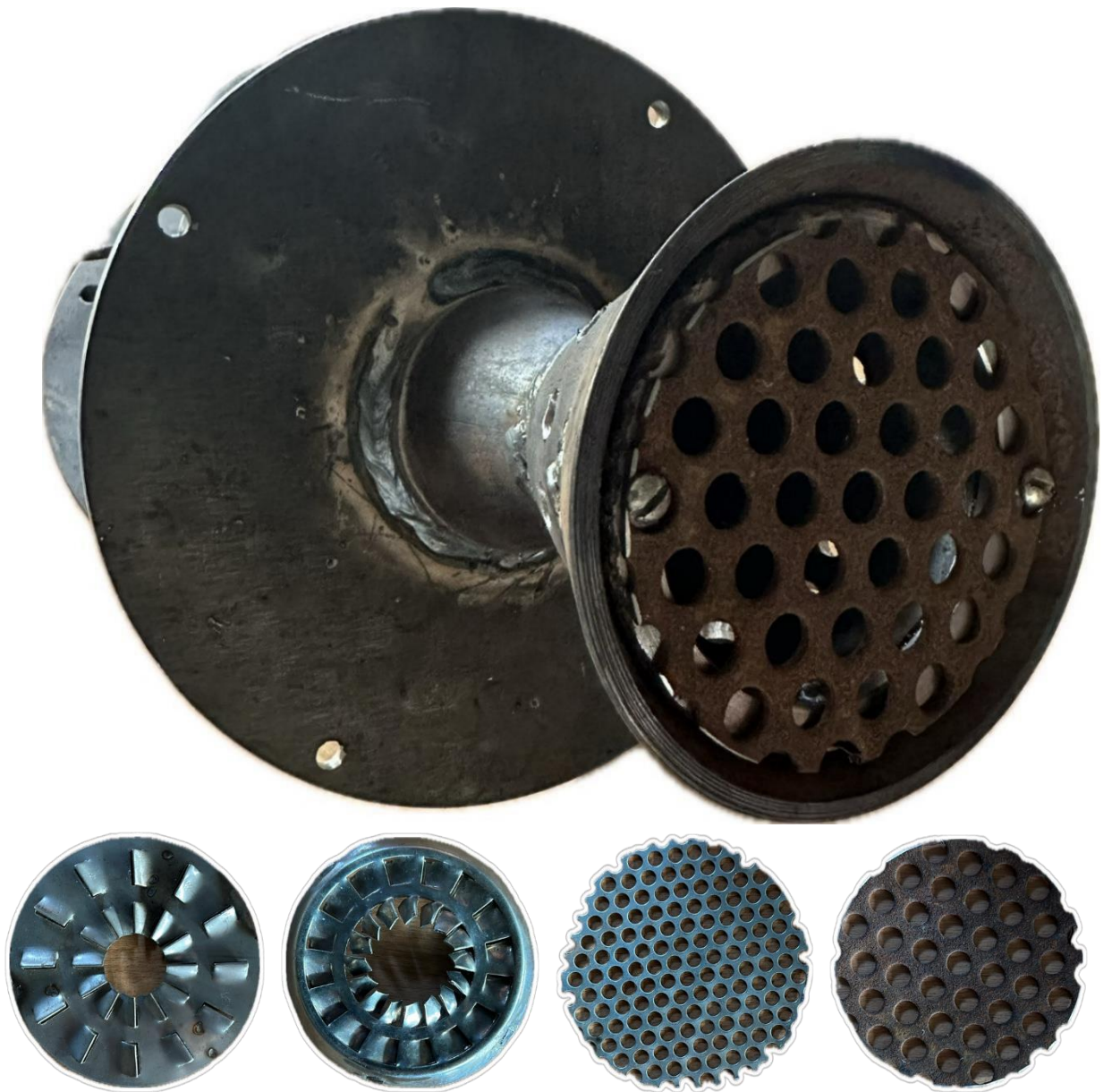
Рисунок Г.2 – Экспериментальное горелочное устройство с исследуемыми насадками
