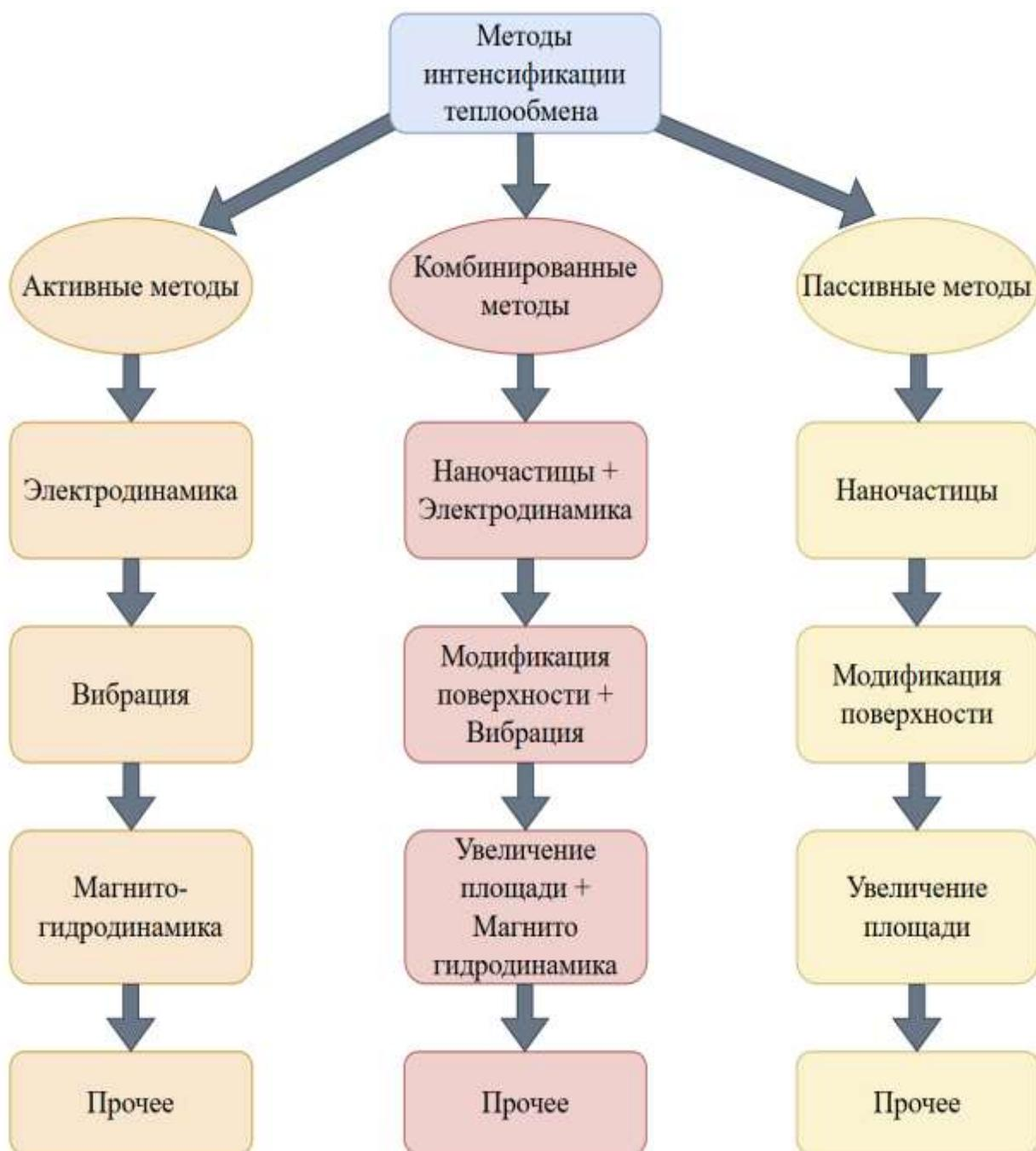
Рисунок 1.6 – Методы интенсификации теплообмена в трубах
