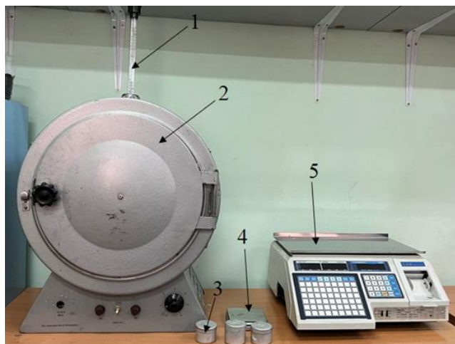
1 – термометр; 2 – сушильный шкаф; 3 – бюксы; 4 – весы высокоточные; 5 – весы для взвешивания общей массы продукта
