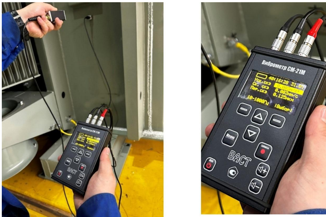
Сурет 6 – РОМ-60000/525-У1 реакторының резервуар қабырғасының және салқындату жүйесінің діріл қозғалысын өлшеу процесі
