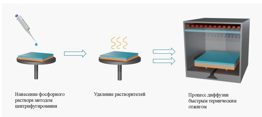
Рис. 1 – Иллюстрация процесса нанесения покрытия и предварительной термообработки пленок PSG, а также процесса диффузии с использованием быстрого термического отжига
