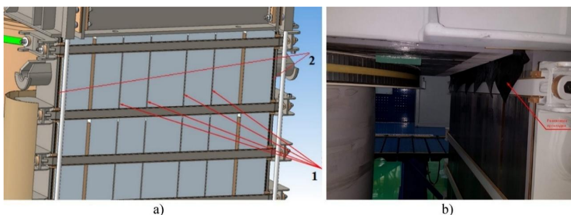
Сурет 2 – реактордың (а) 3D моделіне резеңке төсемдерді орнату: 1-магниттік жүйенің пакеттері арасында (магниттік жүйенің пакеттері арасында 0,5 мм резеңке төсемдер); 2- балка мен ядро арасында (балка мен ядро арасында 4 мм резеңке төсемдері); жиналған реакторда (b)
