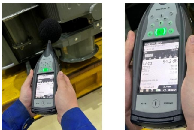
Сурет - 5 -РОМ-60000/525-У1 реакторының дыбыс деңгейін өлшеу процесі
